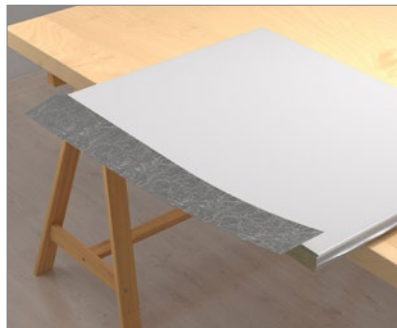
3. Leg 5 mm overlap op de zichtzijde van het paneel en druk de tape aan.
